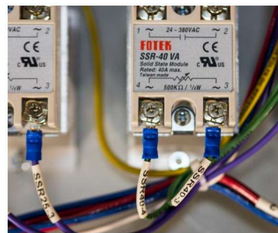
SSR-40 — heat control module
